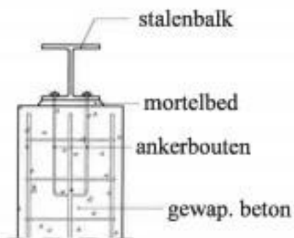
DETAIL OPLEGGING EN VERANKERING STALEN BALKEN
